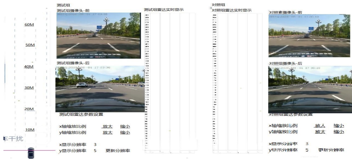
图 9 因干扰而产生的探测距离变短现象
